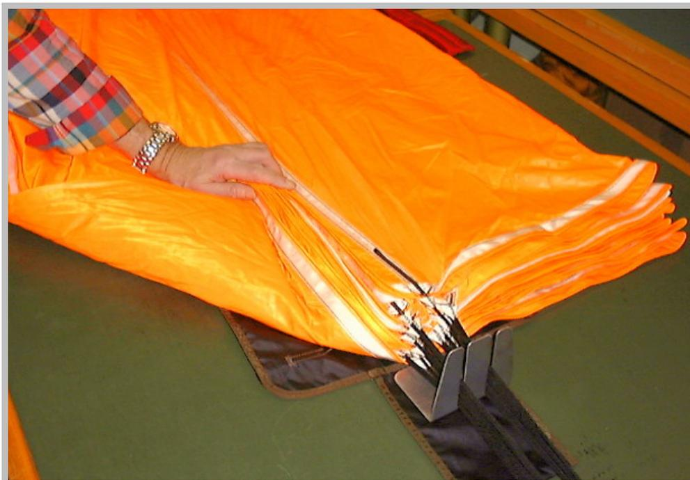
Abb. 10 Linker Basisrand eingeschlagen
