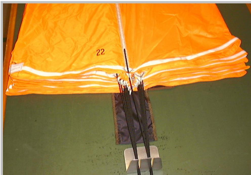
Abb. 9 Bahnen in zwei Gruppen ausgelegt. Die Fangleinen Nr. 1-11 liegen auf der linken Seite, die Fangleinen Nr. 22-12 auf der rechten Seite
