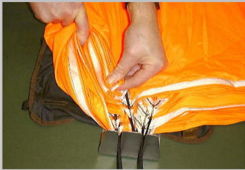
Abb. 11 Spitze des linken Basiseinschlages zurückgeschlagen
