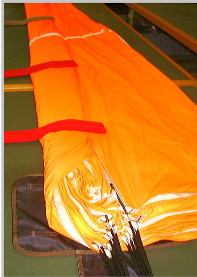
Abb. 12 linke Kappenhälfte längsgefaltet
