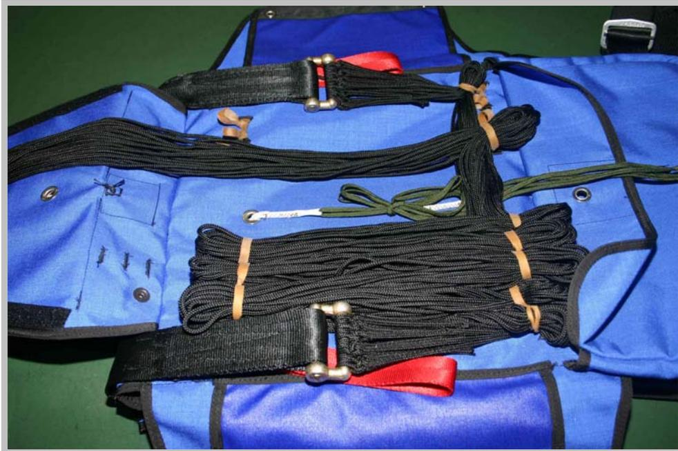
Abb. 24 Fangleinen links mit 3 Einschlaufungen oben, 4 Einschlaufungen unten und 1. Einschlaufung rechts befestigt
