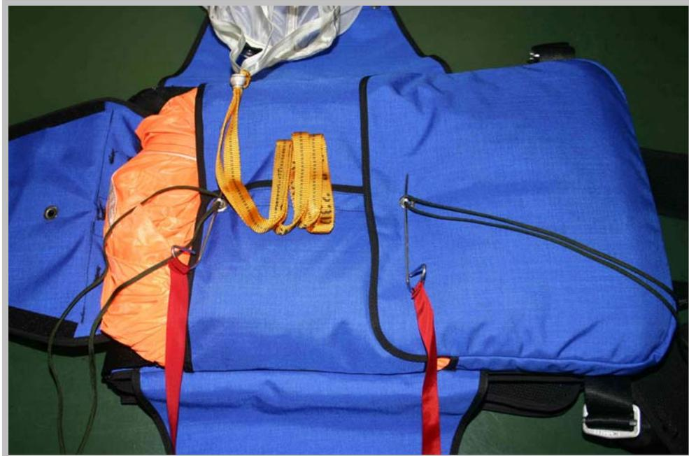
Abb. 31 Hilfsschirmverbindungsleine auf Verpackung ordnen
