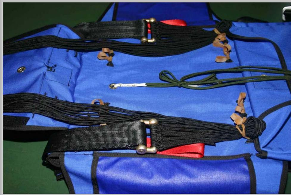
Abb. 22 Haupttragegurt in Verpackung gelegt und Fangleinen rechts und links eingeschlaucht (Packgummis zweifach umschlungen).
